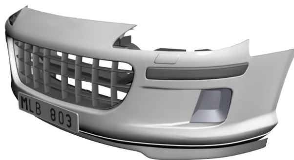
Exempel på stötfångare där "grillen" inte går att demontera och kräver extra svår maskering.
